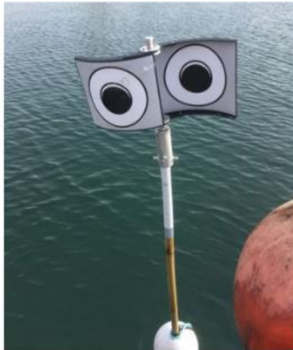
Figura 12. Modelo de boyas con looming-eyes u “ojos amenazantes” empleado en Islandia para intentar espantar a las aves marinas y así reducir su captura en las redes de pesca (tomado de Rouxell et al., 2023).
