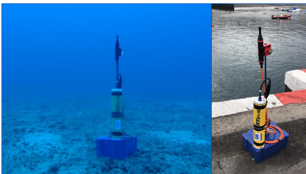
Fotografía 1. Vista del fondeo instalado. Diseño del fondeo de hidrófono propuesto.
