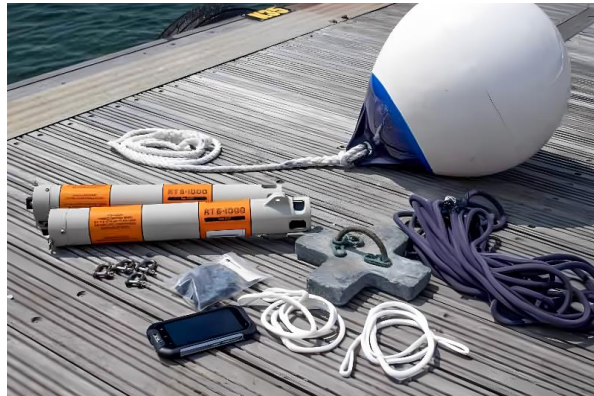
Fig.7. Liberador acústico. SONARDYNE modelo RT6-1000
