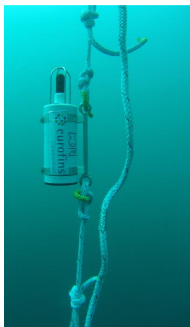
Fig.7. Hidrófono. ABYssens modelo DORI recorder
