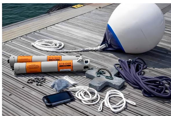
Fig.8. Liberador acústico. SONARDYNE modelo RT6-1000
