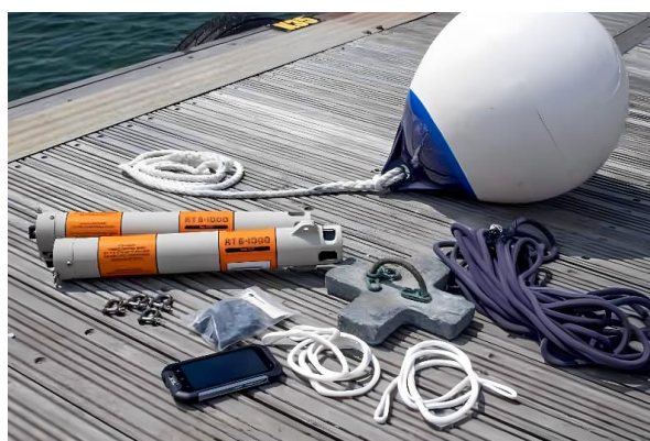
Fig.33. Liberador acústico. SONARDYNE modelo RT6-1000
