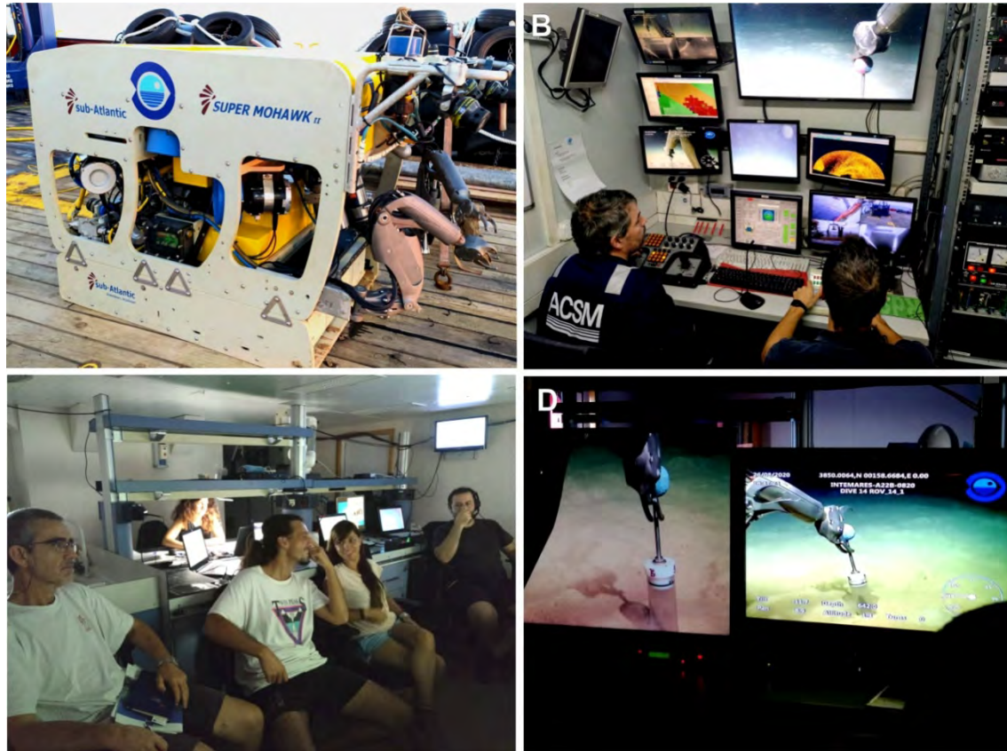
Figura 3.14. A) ROV Liropus 2000 utilizado durante la campaña de investigación oceanográfica INTEMARES-A22B-0820 para la visualización y registro del fondo marino, así como para el muestreo de sedimentos, rocas y organismos bentónicos. B) Puesto de pilotaje del ROV dentro del contenedor de mando. C) Puesto de navegación ( Survey ). D) Visualización de las inmersiones en el laboratorio principal. En esta última imagen se muestra la obtención de un testigo de presión con el ROV.
