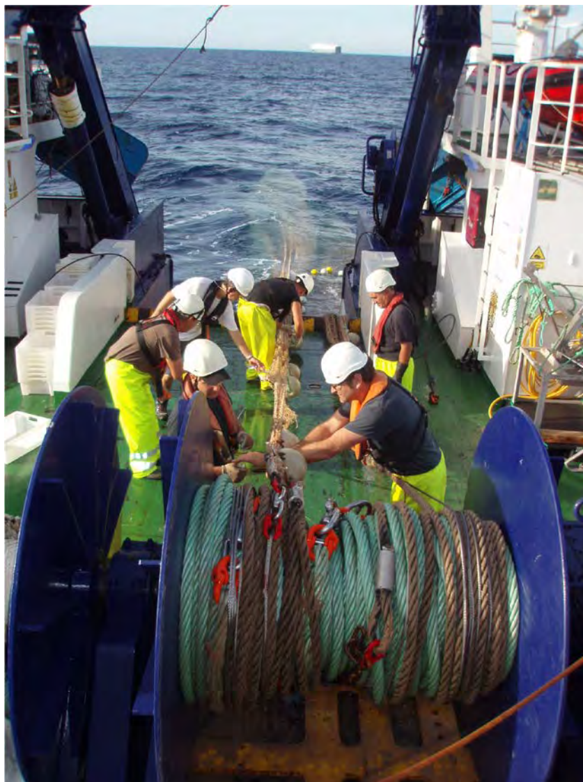
Figura 3.23. Arte de arrastre experimental GOC-73, utilizada a bordo del B/O Ángeles Alvariño para la toma de muestras de fauna necto-bentónica y recursos demersales en caladeros de la flota de arrastre, durante la campaña de investigación oceanográfica INTEMARES-A22B-1019.
