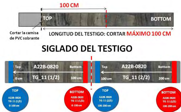
Figura 3.17. Esquema del protocolo de preparación y etiquetado de los tubos de PVC de sedimento recuperados con el testigo de gravedad durante la campaña de investigación oceanográfica INTEMARES-A22B-0820.
