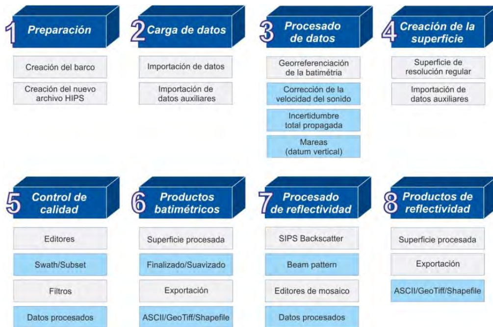
Figura 3.28: Flujo de trabajo del procesamiento de los datos de ecosonda multihaz para la obtención de superficies batimétricas y de reflectividad del fondo marino.
