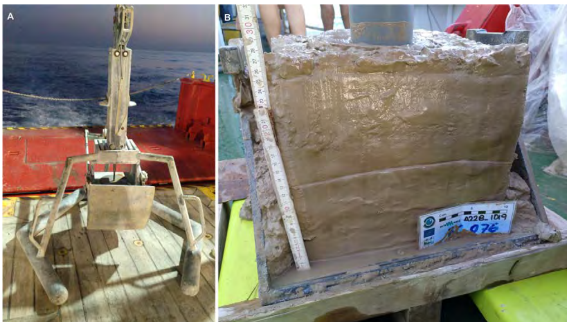
Figura 3.10. A) Draga box-corer utilizada durante la campaña de investigación oceanográfica INTEMARES-A22B-0820 para la toma de muestras de la columna sedimentaria y B) mesa de tamizado para la separación de la infauna contenida en los sedimentos superficiales.
