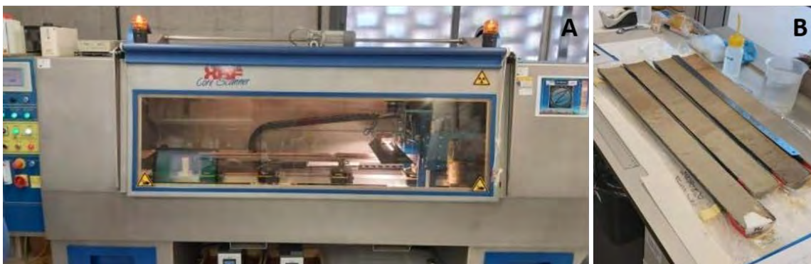
Figura 3.33: A) Equipo de análisis geoquímico no destructivo Avaatech XRF Core Scanner del laboratorio CORELAB de la Universitat de Barcelona. B) Secciones de trabajo de uno de los testigos de sedimento de la campaña de investigación oceanográfica A22B-0820, para realizar la descripción sedimentológica y el muestreo discreto en el Laboratorio de Arcillas del Instituto Andaluz de Ciencias de la Tierra (IACT-CSIC).
