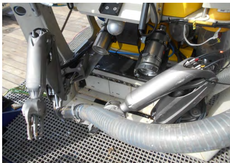
Figura 25. Detalle de los brazos y cámaras del ROV LIROPUS 2000 (Foto: A. Ramos).
