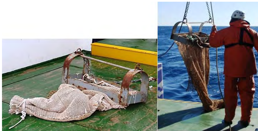
Figura 20. Draga de patines. A la izquierda, detalle de la boca del aparejo; a la derecha, aumento del peso de la boca con eslabones de cadena (Foto: A. Ramos).
