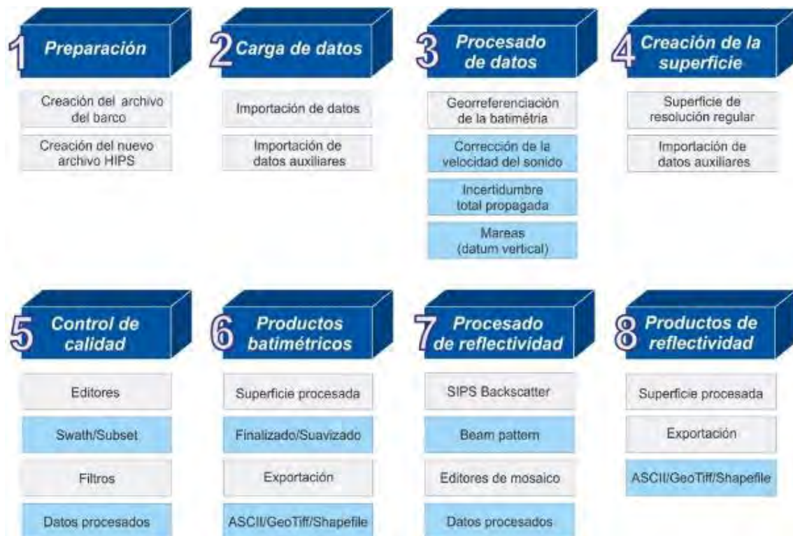
Figura 15. Flujo de trabajo del procesamiento de datos de la ecosonda multihaz para la obtención de los mapas batimétricos y de reflectividad del fondo marino.
