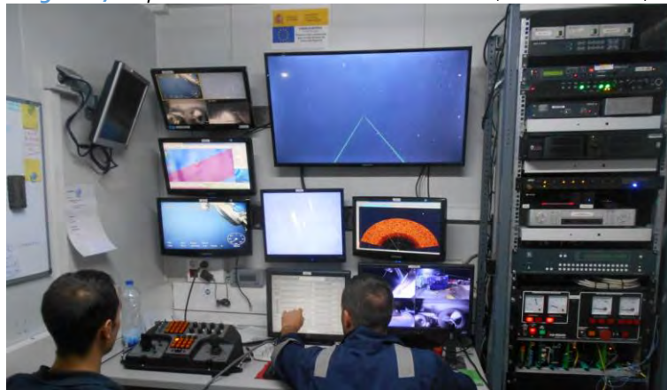
Figura 27. El puesto de control del LIROPUS 2000 (Foto: A. Ramos).
