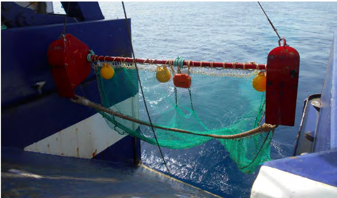
Figura 21. Izando el arrastre de vara. Se aprecia el copo flotando en el agua (Foto: A. Ramos).
