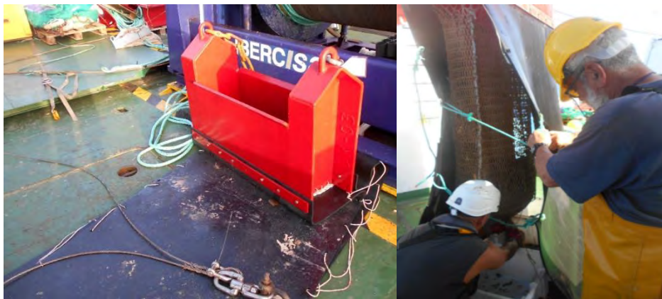
Figura 19. Draga de roca. Izquierda: detalle de la boca del aparejo y las cubiertas protectoras (Foto: A. Ramos). Derecha: vaciado del copo tras un lance.
