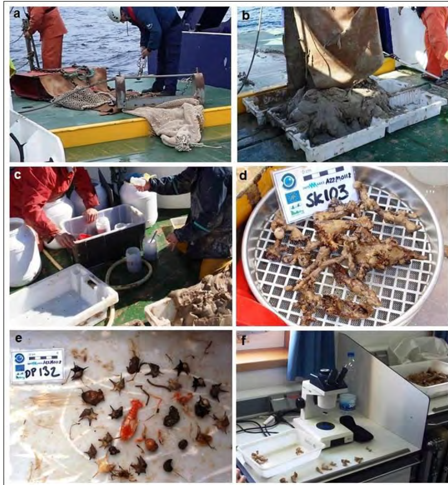
Figura 29. Etapas del muestreo a bordo: a. Dragas de roca y patines; b. Reparto de la muestra en cajas; c. Separación de visu; d. Tamizado; e. Fotografiado y posterior separación; f. Clasificación.
