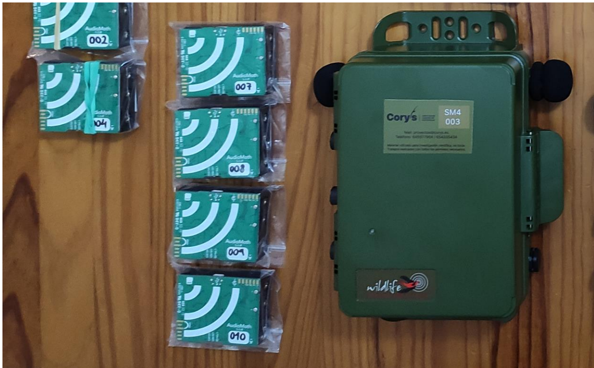
Figura 20. Modelos de grabadoras AudioMoth y SM-4 utilizadas para los muestreos.
