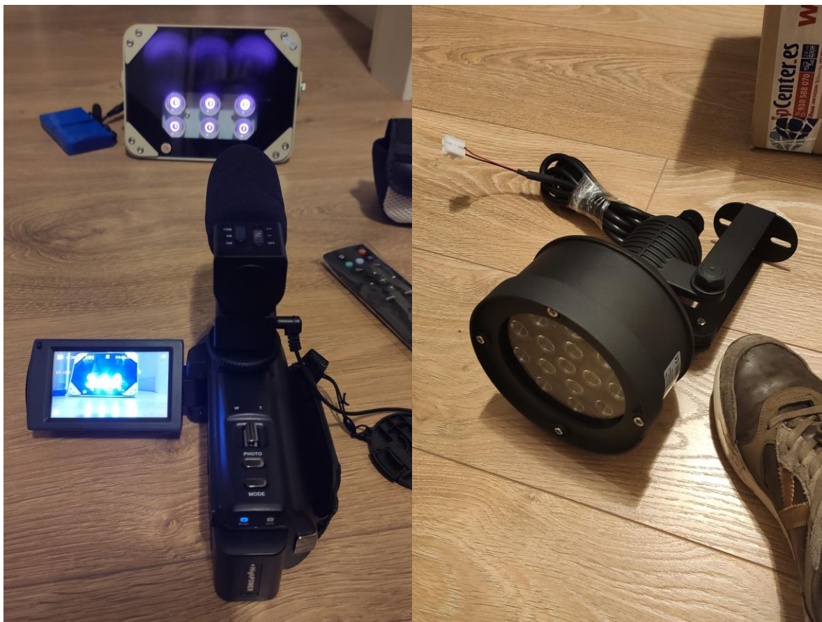
Figura 18. Modelo de cámara IR utilizado inicialmente en el proyecto.
