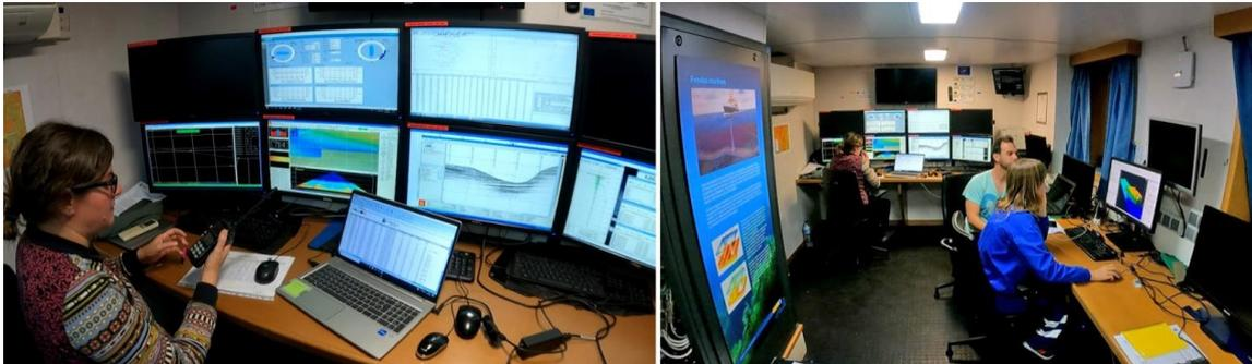
**Figura 20.** Detalles de la adquisición y procesado de datos acústicos (ecosonda multihaz y sonda paramétrica TOPAS) en el laboratorio de acústica del B/O Ramón Margalef.
