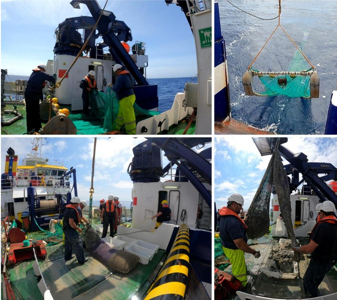
**Figura 26.** Detalles del beam-trawl usado en cubierta y durante su largado por la rampa de popa (arriba) durante la campaña INTEMARES A<sub>4</sub> CAD. Muestra recolectada por el beam-trawl sobre cubierta (abajo izquierda) y reparto de la muestra en diferentes cajas para su posterior procesado (abajo derecha).
