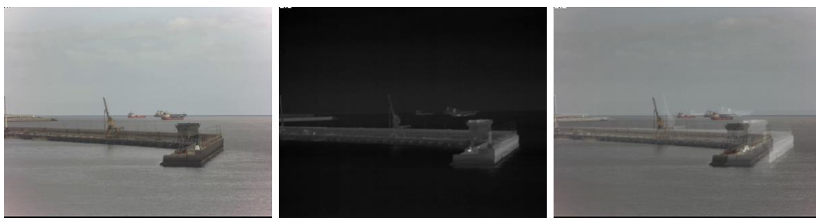
Figura 14. Ejemplo de desalineación espacial. A la izquierda la imagen RGB, en el centro la imagen IR y a la derecha ambas imágenes superpuestas.
