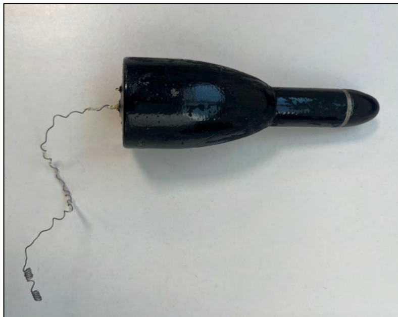
Imagen 29. Aspecto de una de las marcas recuperada con daños en la antena.
