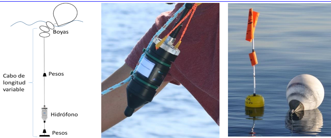
Figura 9. Despliegue de equipo de grabación acústica SoundTrap . Imagen izquierda: Esquema de instalación; Imagen central: dispositivo SoundTrap ; Imagen derecha: dispositivo de grabación a la deriva con sistema de boyas y localización.
