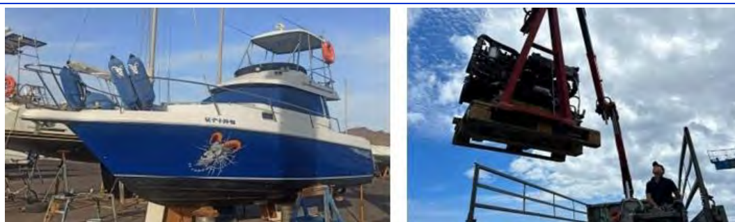
Figura 26. Fotografías de la embarcación Puerto Azul Uno durante su varada y de la retirada tras el desmonte del puente para la reparación de los motores.
