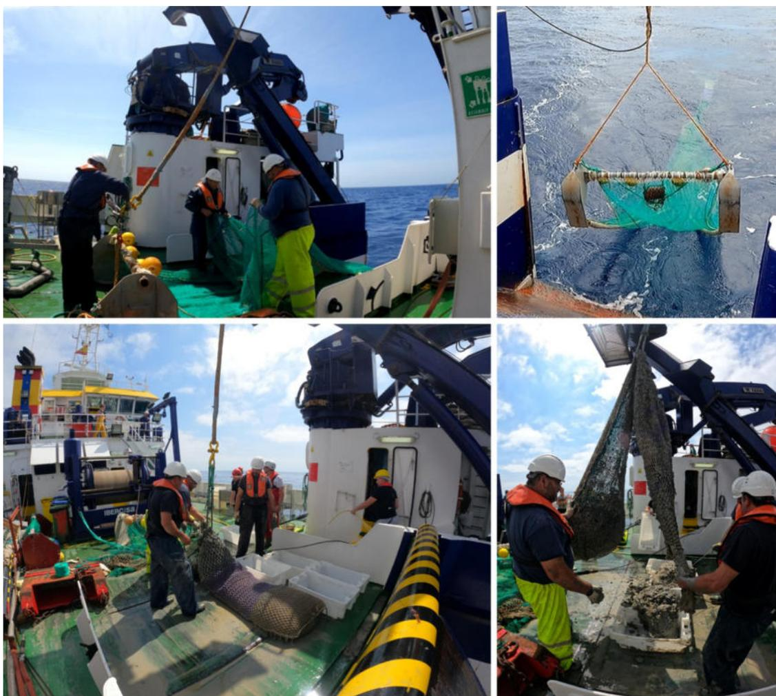
**Figura 7.** Detalles del Beam-trawl en cubierta y durante su largado por la rampa de popa (arriba). Muestra recolectada por el Beam-trawl sobre cubierta (abajo izquierda) y reparto de la muestra en diferentes cajas para su posterior procesado (abajo derecha).
