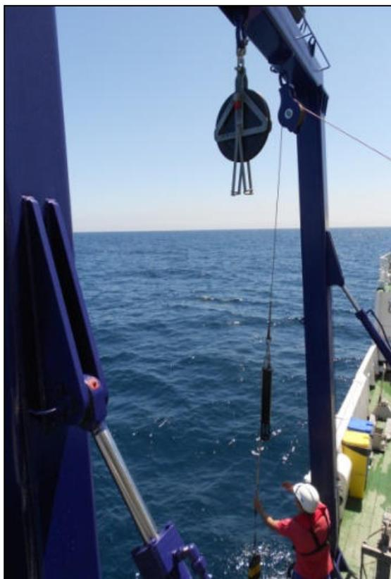
**Figura 16.** Maniobra de largada del perfilador de velocidad del sonido AML SVP Plus por el costado de estribor del B/O Ramón Margalef.
