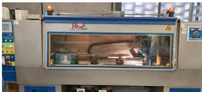
mediante un escáner de fluorescencia de rayos-X (XRF Core Scanner, AVAATECH; ver fotografía) a una resolución de 1 cm y usando dos intensidades: 10 kV para determinar Al, Si, P, S, K, Ca, Ti, V, Cr, Mn, Fe; y 30 kV para determinar Ni, Cu, Zn, Br, Rb, Sr, Zr y Mo.
